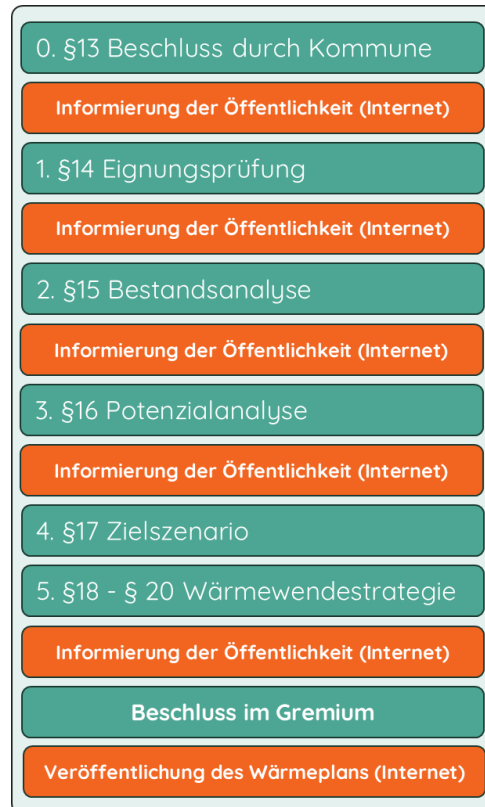
Abbildung 2: Ablauf einer Wärmeplanung nach § 13 WPG
